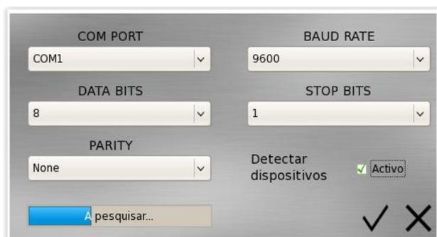
Esta janela, *popup*, por defeito, tem a opção de detectar dispositivos desabilitada para o caso de querer apenas alterar as definições do porto RS-232. Caso active a deteção, a barra de progressão indicará o avanço do processo que após finalização irá actualizar a árvore de dispositivos de forma automática.
