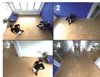
Cuatro cámaras PTZ virtuales de una sola cámara hemisférica 360°
