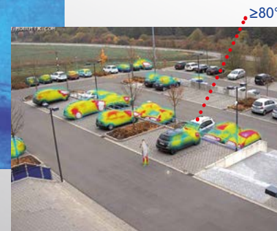
Solapamiento de Imagen Térmica sobre Óptica
