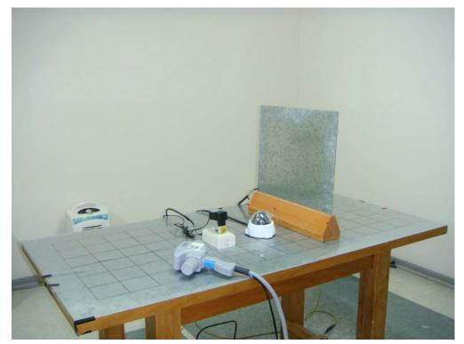
Test Mode : Mode 2: PoE Mode Description : ESD Test Setup
