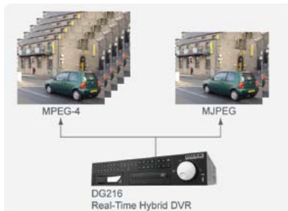
A Função Dual-Codec possibilita ao utilizador escolher compressão MPEG-4 / MJPEG em diferentes aplicações
