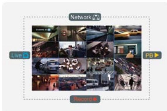
A operação Triplex+ permite aos utilizadores gravar, ver em directo e reproduzir vídeo, e simultaneamente aceder remotamente através da rede
